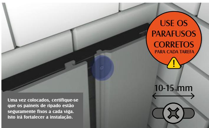
**6** Certifique-se de que o espaço entre as vigas permanece vazio, permitindo que o ar flua sob as régua de ripado. Encaixe a segunda régua na primeira e repita o processo de fixação, certificando-se de que a segunda placa esteja firmemente encaixada em cada viga. Repita este processo com cada régua de ripado até atingir a altura desejada.
