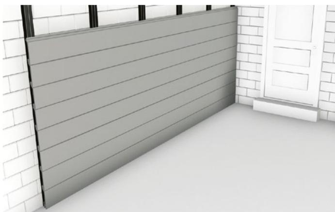
**7** Continue a encaixar as régua de ripado dessa forma até cobrir completamente a área desejada. É possível encaixar suas régua lado a lado simplesmente juntando as duas pontas. Pode ser necessário instalar mais vigas se desejar fazer isso, pois cada régua precisa ser apoiada em uma viga onde se encontre com a próxima régua de ripado.
