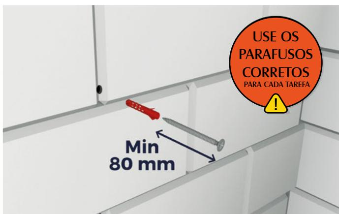
**2** É necessário pré-perfurar as vigas de subestrutura e a superfície da parede usando uma broca de 6 mm. Os sarrafos têm 25 mm de altura e é preciso prendê-los pelo menos a 50 mm da extremidade. Escolha as fixações adequadas para a parede em que está a instalar o ripado. Os parafusos devem ter 5-6 mm de diâmetro e pelo menos 80 mm de comprimento\*.
