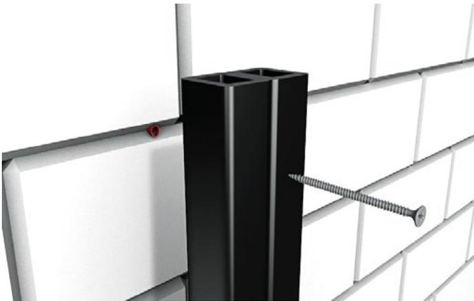
**1** É necessário pré-perfurar as vigas de subestrutura e a superfície da parede usando uma broca de 6 mm. Os sarrafos têm 25 mm de altura e é preciso prendê-los pelo menos a 50 mm da extremidade. Escolha as fixações adequadas para a parede em que está a instalar o ripado. Os parafusos devem ter 5-6 mm de diâmetro e pelo menos 80 mm de comprimento\*.
