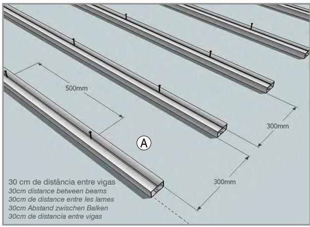
Fixação das Vigas directamente ao solo, a cada 50cm, e a 10cm das extremidades
